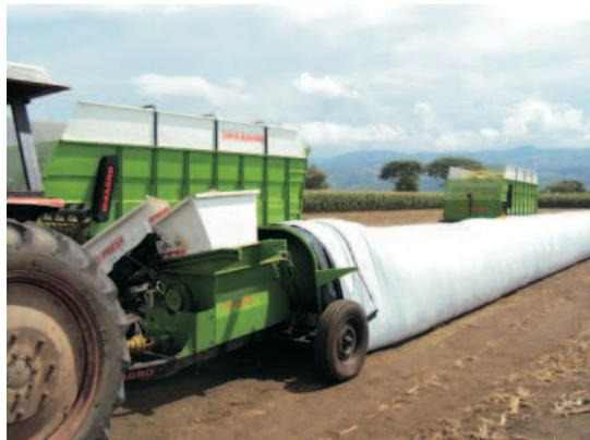
Rendimientos hasta de 20 toneladas por hora con baja cantidad de mano de obra. A medida que el material ingresa en la bolsa se crea una condición anaeróbica.
